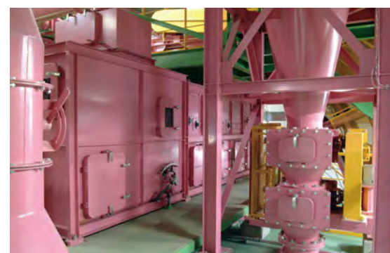
高松市南部クリーンセンター プラスチックごみ風力選別機
